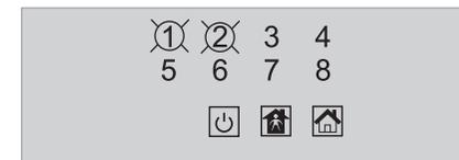
部防区的撤防操作，将清除防区报警状态和关闭布撤防状态指示。下图为撤防防区列表=1, 2, 3, 4, 5, 6, 7, 8，防区8为24小时防区的状态显示。
